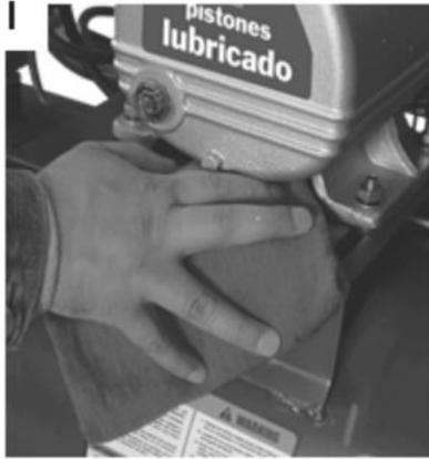
**LIMPIEZA:** Mantenga limpio el interior y exterior del compresor. Cambie el aceite regularmente, y mantenga limpias todas las superficies externas. Un interior limpio asegura una buena eficiencia mecánica, y un exterior limpio permite una disipación más eficiente del calor al aire circulante. Fig. I
