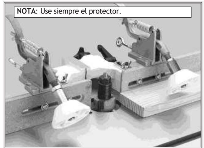
Figura 4. Utilice pisadores para detener la pieza.
