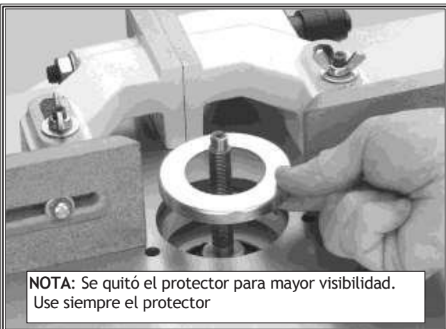
Figura 3. Usar el separador más pequeño para evitar que entre aserrín a la fresa.
