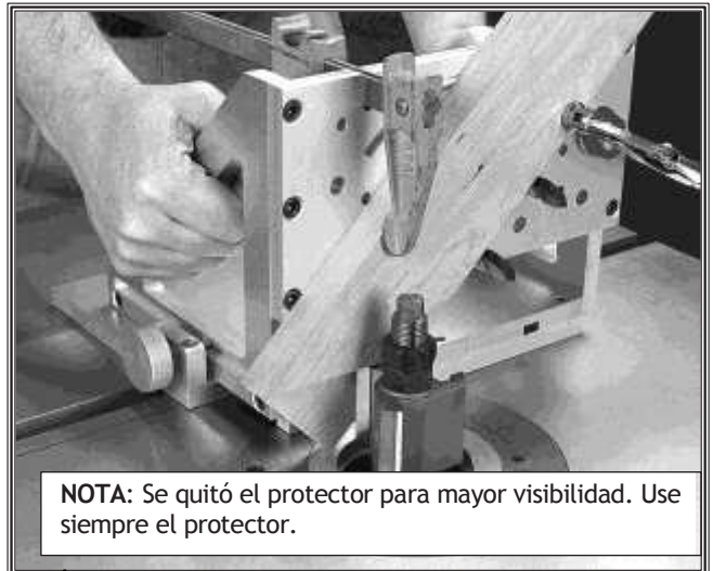
Figura 5. Utilice ascensor para hacer cortes especiales sin el protector.
