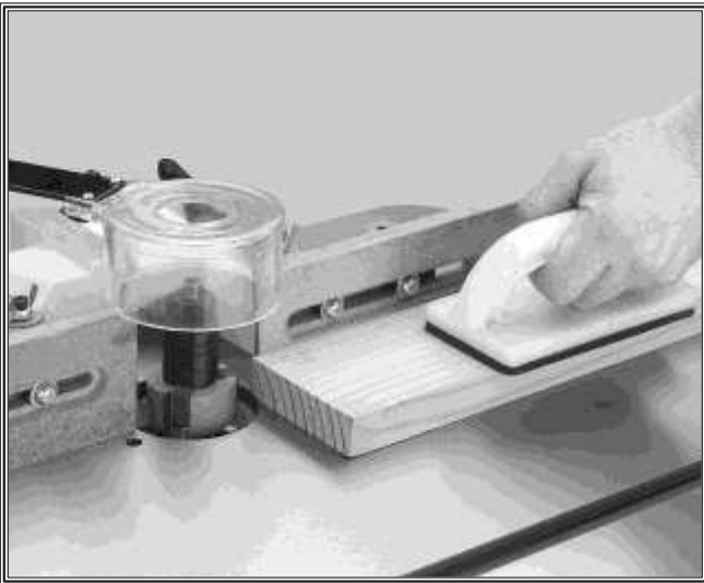
Figura 2. Utilice pisadores manuales Para detener la pieza al cortarla.
