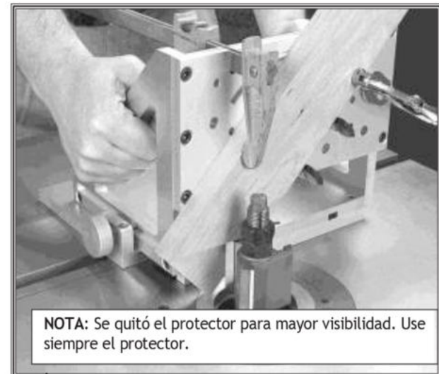
Figura 5. Utilice accesorios para hacer cortes especiales sin el protector.
