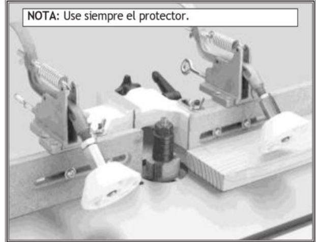
Figura 4. Utilice pisadores para detener la pieza.
