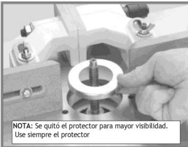
Figura 3. Usar el separador más pequeño para evitar que entre aserrín a la fresa.
