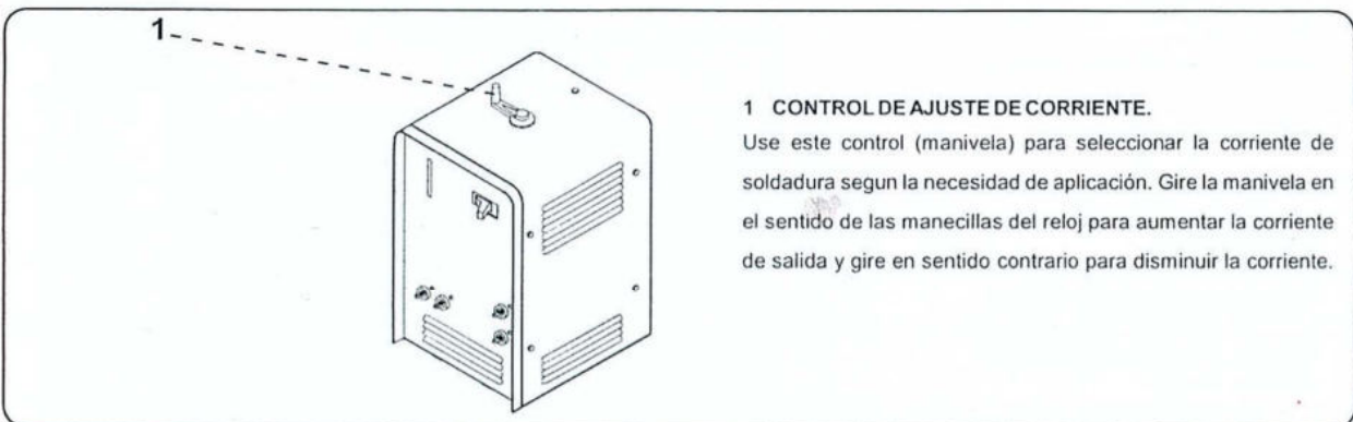
Figura 4-4. Control de ajuste de corriente
